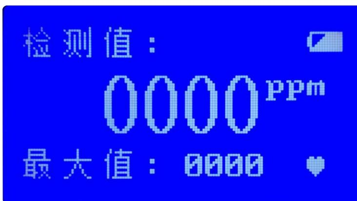
进入待机状态这时“♥”不会闪烁。待机界面会显示“检测值：0000ppm”，“最大值：0000”，电池电量。
